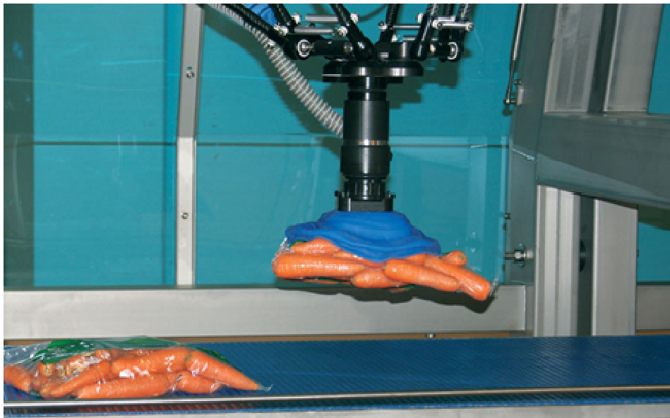
Figur 8 Octomations octogripper pækker gulrotsekker
