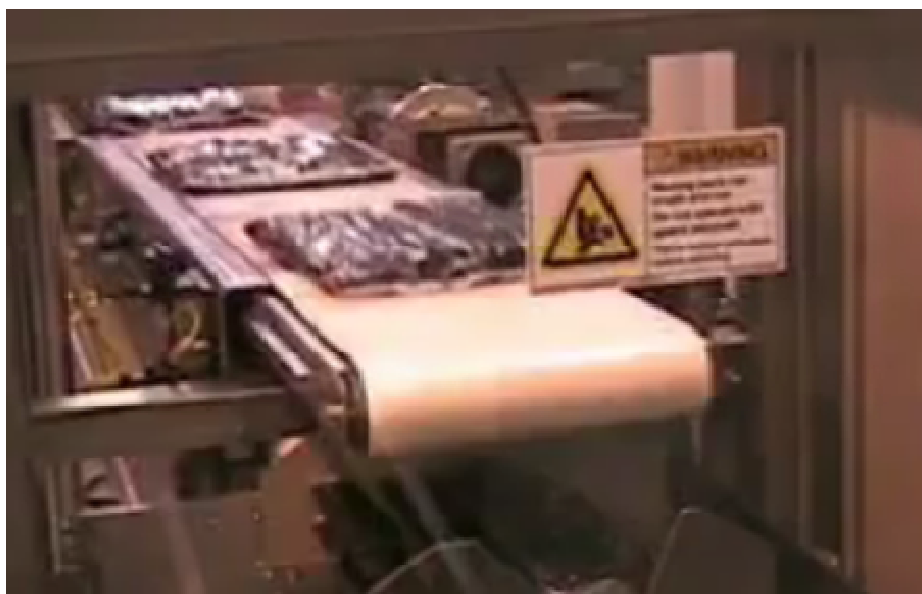
Figur 9. Pækkeløsning (Pull nose conveyor) for plate suppeposer fra Combi Packing Systems
