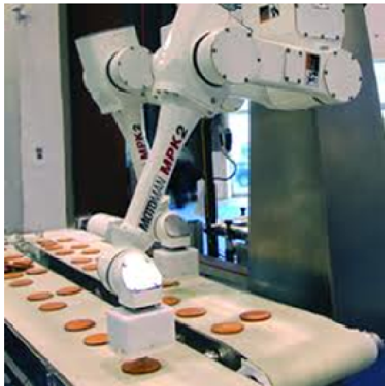
Figur 5. 6-akse robot fra Motoman
